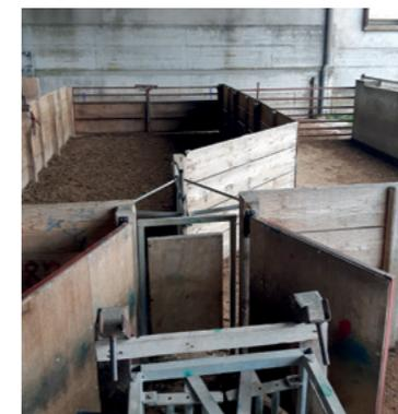
de se blesser lorsqu'ils doivent attraper, isoler et soigner un animal. Le système des cornadis installés dans un couloir d'alimentation central est souvent le premier équipement mis en place. Il permet déjà d'isoler facilement un animal. Un parc de tri et de contention nécessite un espace bétonné et couvert. Il intègre différents équipements comme des portes, des couloirs ou des cages de retournement qui permettent de réparer les onglons puis de diriger les brebis facilement vers des pédiluves.
